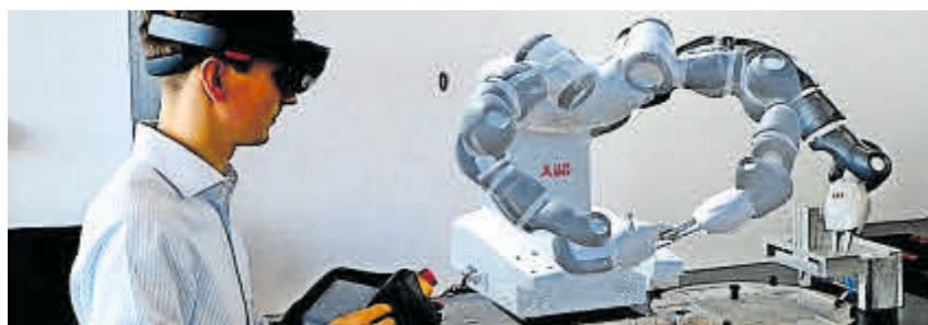
Programmierung eines Roboters mit Mixed Reality am VAL. Foto: Hochschule
